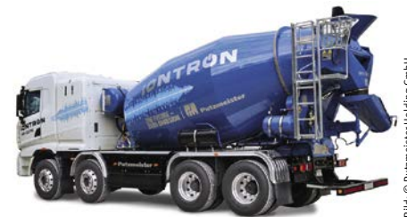
Der vollelektrische E-Betonmischer IONTRON von Putzmeister, dessen Batterie eine Leistung von 350 kWh hat.
